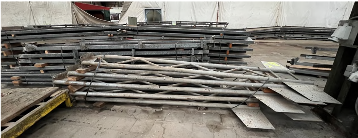
Derrière : 5 pieds-droits tubulaires, 10 pieds-droits en tôle pliée, et les lisses
