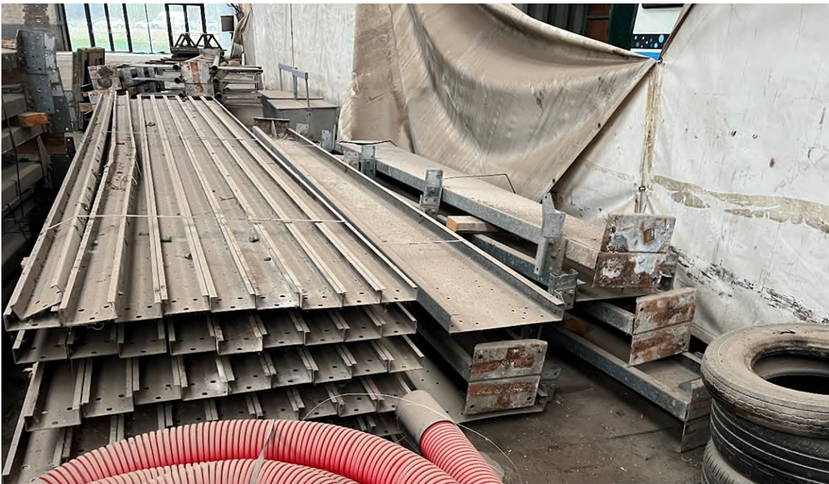
Derrière : 7 pieds-droits en tôle pliée et des lisses
