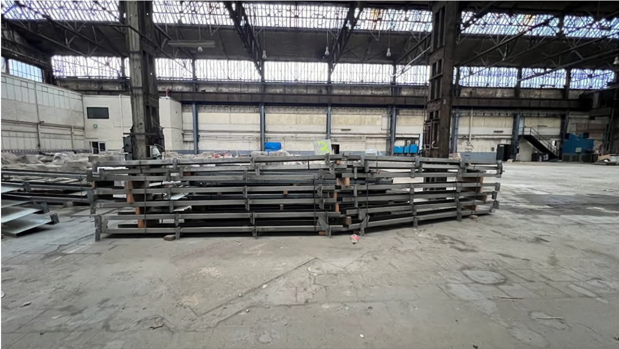
Derrière : 5 pieds-droits tubulaires, 10 pieds-droits en tôle pliée, et les lisses
